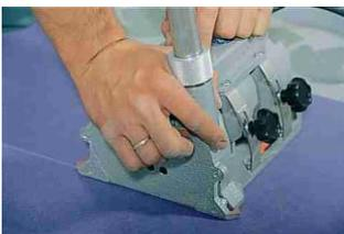
Герметизация швов сварочным шнуром осуществляется с помощью аппарата для ручной сварки со специальной насадкой 5 мм. Температура сварки составляет 400-450 С°, скорость примерно 4-5 метров в минуту.
